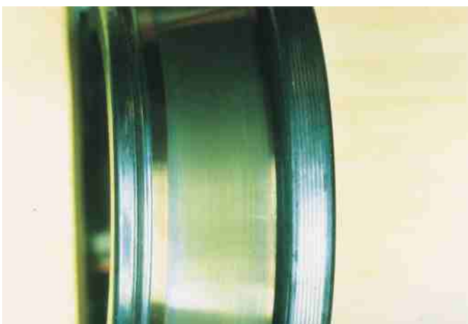
Abb. 5: Foto der Innenring-Laufspur - aus Versuch siehe Diagramm 4, S. 10 , Schmierung mit TURMOTEMP® LP 5002
