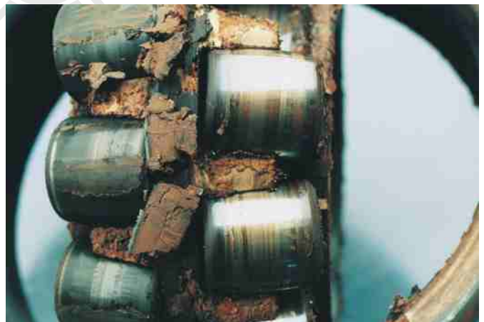
Abb. 4: Fotos von Rollenmantelflächen sowie der Innenring-Laufspur des Lagers - aus dem Versuch siehe Diagramm 3, S. 9
