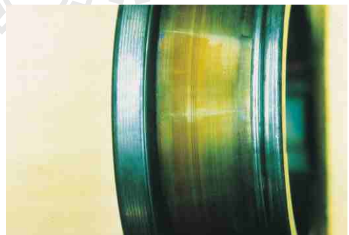
Abb. 6: Foto der Innenring-Laufspur - aus Versuch siehe Diagramm 5, S. 10 , Schmierung mit PFPE/PTFE-Paste
