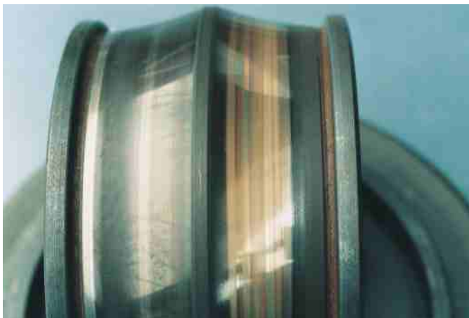
Abb. 4: Fotos von Rollenmantelflächen sowie der Innenring-Laufspur des Lagers - aus dem Versuch siehe Diagramm 3, S. 9
